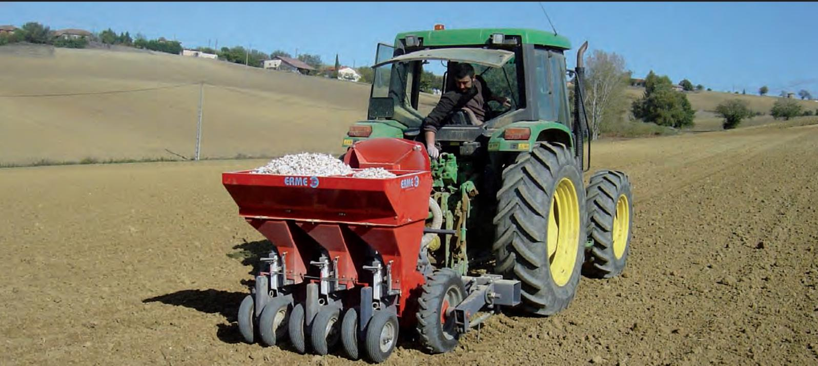
Plantadora neumática de 3 hileras
