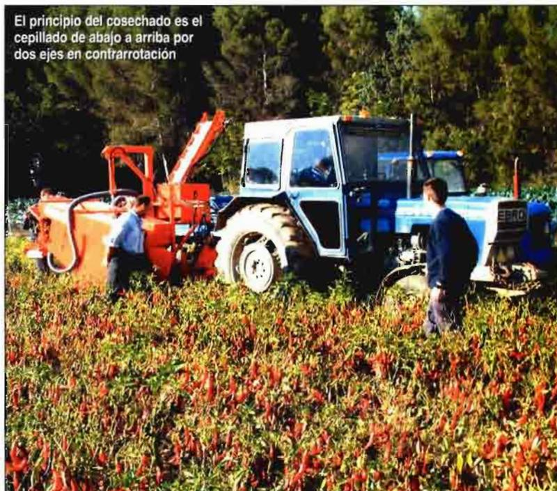
El principio del cosechado es el cepillado de abajo a arriba por dos ejes en contrarrotación
