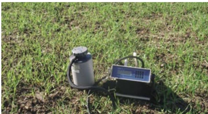
Equipo para medición de CO<sub>2</sub> procedente de la respiración del suelo y analizador de gases por infrarrojos.
