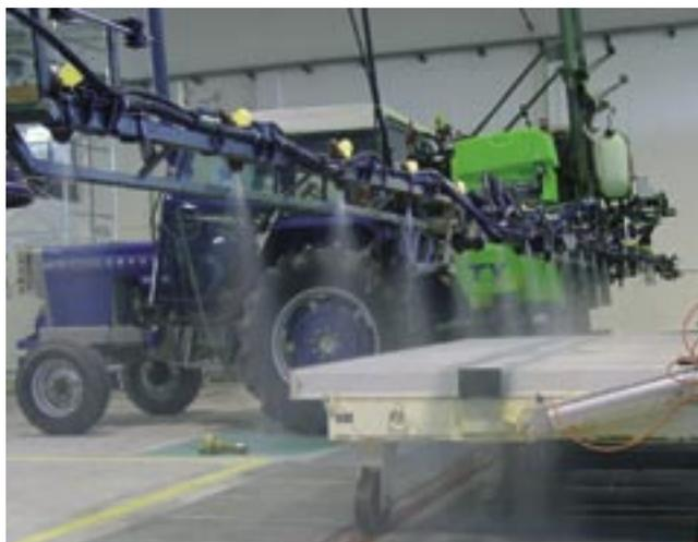
**Foto 2.** Ensayo de la uniformidad de distribución de una barra de pulverización a diferentes alturas en el Centro de Mecanización Agraria de Lleida. Foto CMA
