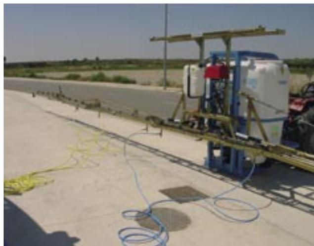
**Foto 5 y 6.** Realización de una inspección a un pulverizador para cultivos extensivos. Determinación del equilibrio de presiones. Foto CMA
