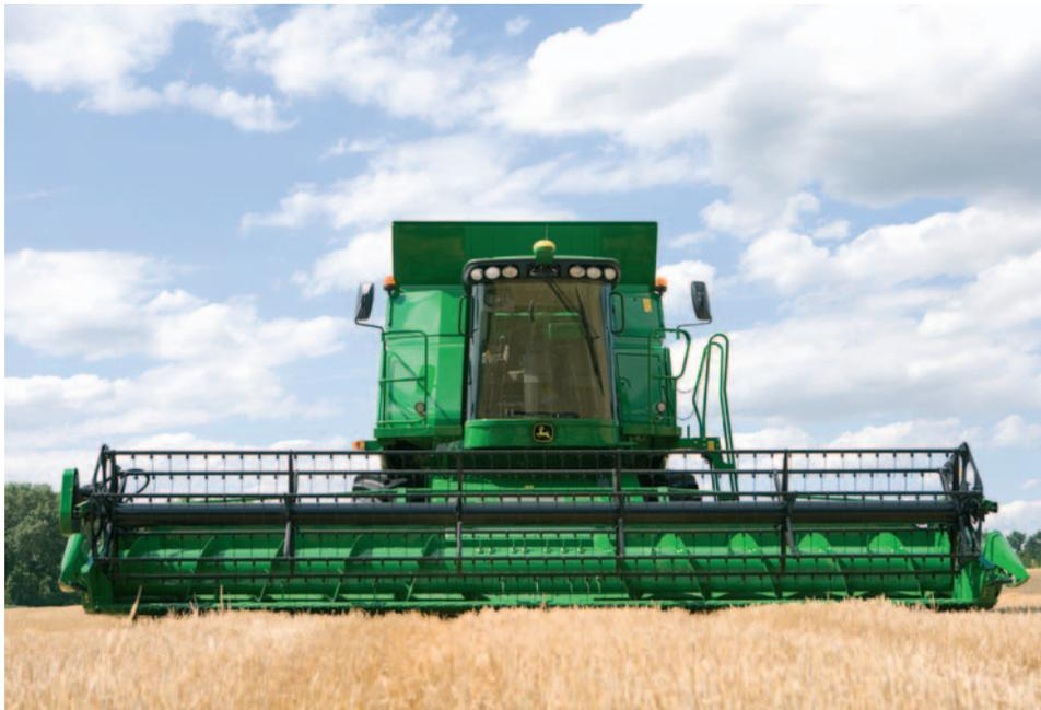
Los modelos más altos de la gama, las cosechadoras S690 y S690i reemplazan a la STS 9880i, con un aumento de potencia de 493 a 530 CV, una plataforma de corte de 9.15 metros y un tanque de 11 000 litros de capacidad. Estos modelos mantienen el exclusivo rotor de alto rendimiento, la gran velocidad de descarga y el sinfín plegable.
