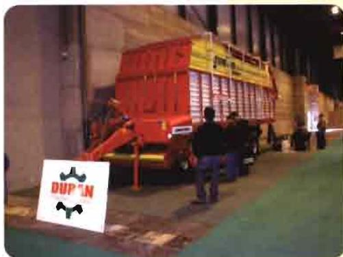
El importador de Pöttinger en España acudió con el remolque autocargador Jumbo 8000 de 78 m<sup>3</sup> de capacidad de carga.
