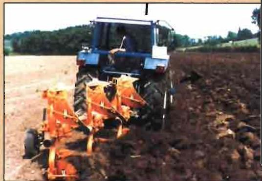
*Si el centro de resistencia del arado no coincide con el plano medio del tractor éste tiende a salirse de su trayectoria normal.*
