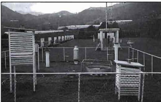
Al lado, el control climático del invernadero es una de las técnicas de difícil aplicación en los invernaderos canarios por la falta de automatización. El uso del termohigrógrafo facilita el control de las temperaturas y la humedad relativa del aire. Abajo, sería conveniente contar con un pequeño observatorio meteorológico en la explotación o en las proximidades, para disponer de información de carácter agro-climático.
