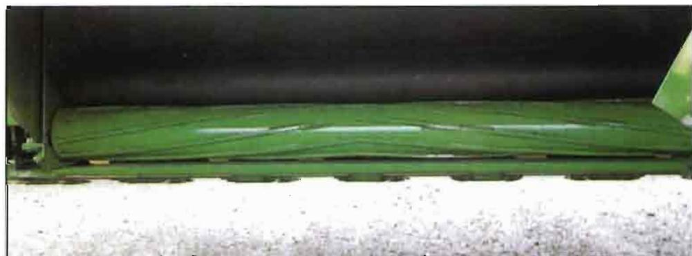
Fig. 3.-Acondicionador con rodillo metálico dentado y rodillo de caucho liso. (Foto: Krone).
