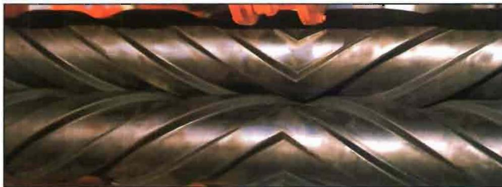
Fig. 2.-Acondicionador de rodillos de caucho acanalados (Foto: Kuhn).
