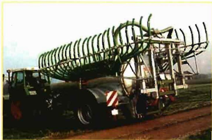
Este sistema forma parte de los brazos de una cuba esparcidora de purín con salidas localizadas a nivel del suelo, para anchuras de trabajo entre 6 y 18 metros.
