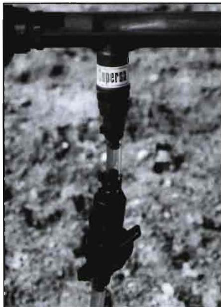
**L**a uniformidad de la distribución de aire dentro de la tubería de riego se logra permitiendo que la mayor parte de agua pase a través del inyector Venturi y con una ligera restricción de presión de aire para crear un vacío parcial.
