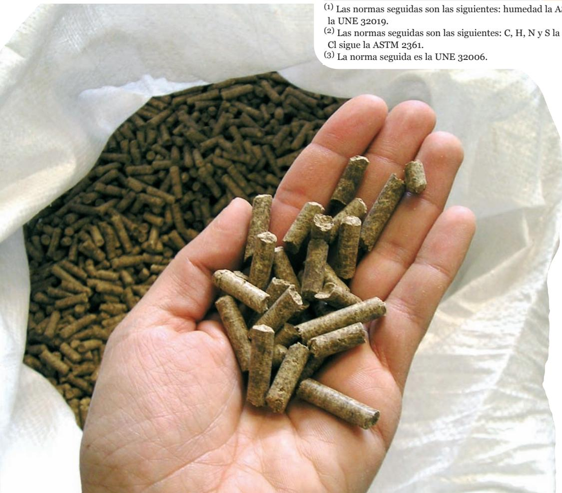
En la trituradora se utilizó un tamiz de cinco mm para obtener partículas inferiores al diámetro de los pelets que se querían producir (seis mm).
