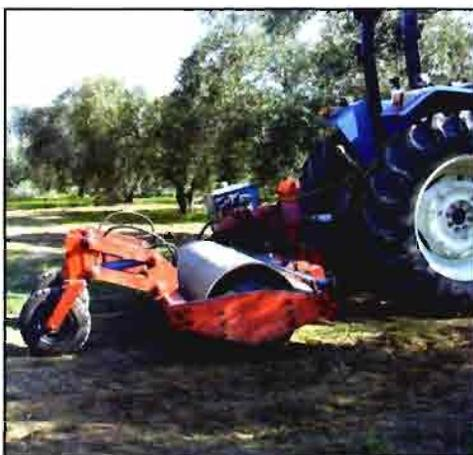
Figura 1. Rulo compactador vibratorio para la preparación de suelos.
