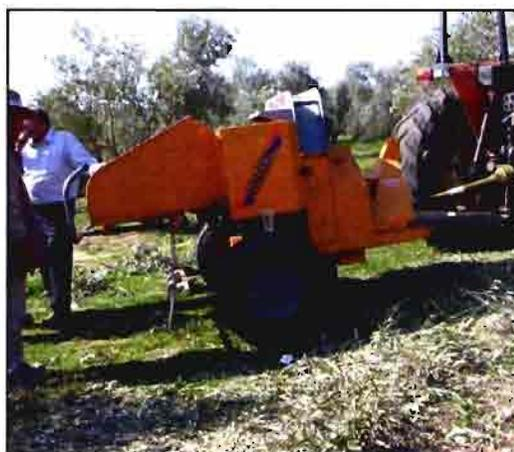
Figura 13. Picadora de alimentación manual.
