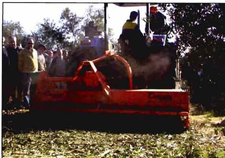
Figura 11. Picadora de ramón autoalimentada de eje horizontal.
