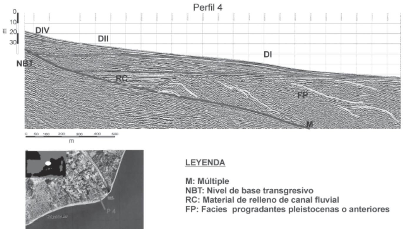
Fig. 3.- Esquema estratigráfico del delta del Tordera.
