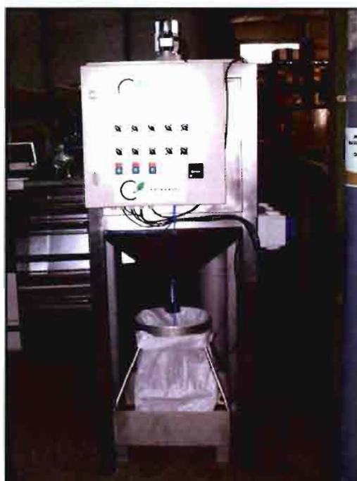
La depuración sigue los siguientes pasos: El equipo de tratamiento funciona en discontinuo, aspirando el agua de una balsa de acumulación mediante una bomba. Un sensor de nivel avisa que la unidad de tratamiento esta llena y empieza el ciclo de tratamiento automático.
