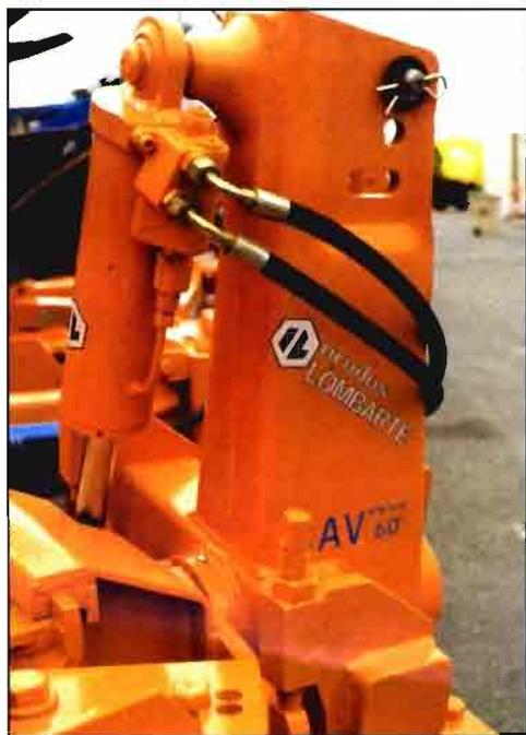
Figura 7.- Cilindro de volteo de un arado de vertedera reversible.
