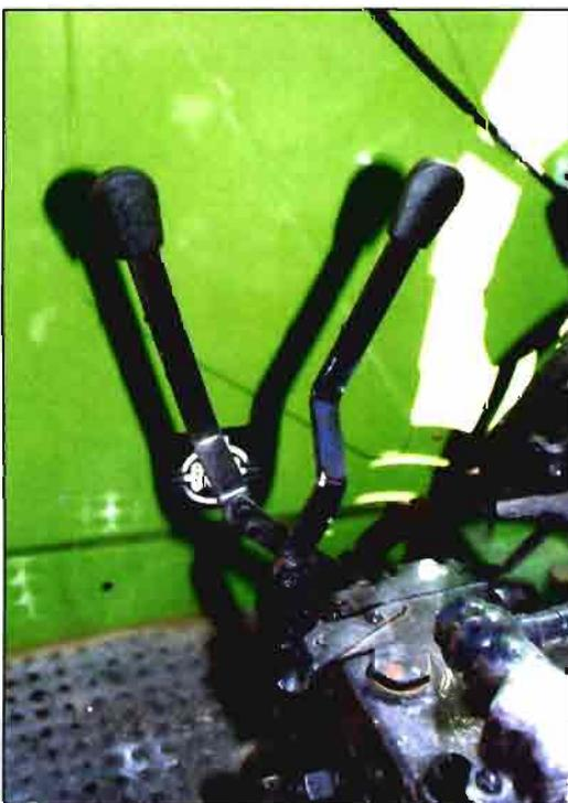
Figura 5.- Palancas de mando de los distribuidores de servicios externos de un tractor.
