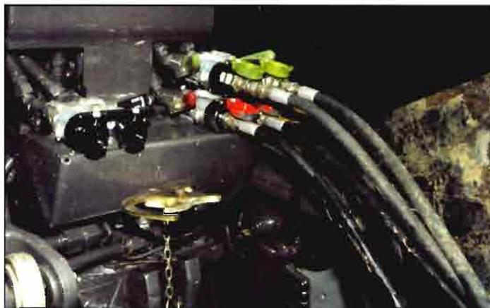
Figura 6.- Conexión de las tuberías de un apero a los acoplamientos rápidos de un tractor.
