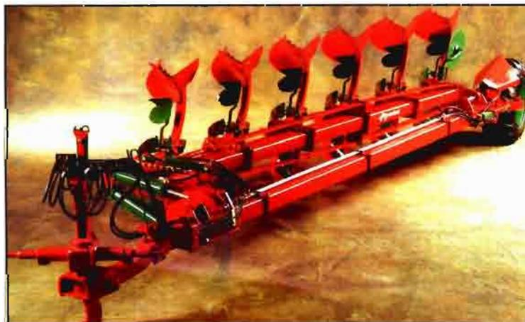
Figura 1.- Incluso las máquinas aparentemente simples, como los arados de vertedera, pueden tener un sistema hidráulico complejo que facilita su trabajo.
