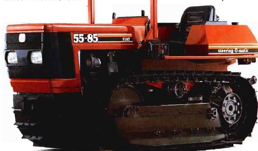
siendo casi totalmente desplazados por los de doble tracción. No obstante, los tractores estrechos de cadenas también presentan novedades tecnológicas como fruto de la investigación de los fabricantes; cabe destacar, por ejemplo, los cómodos sistemas de conducción de New Holland (el sistema Steering-o-matic) y de Landini (el sistema Hi-drive, fig. 4).
