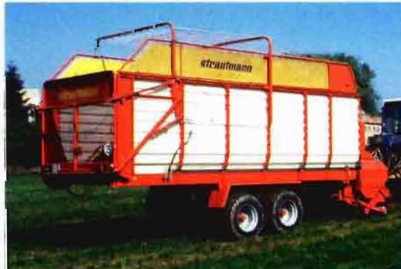
**SUPER VITESSE.** Remolque autocargador-picador de forraje
