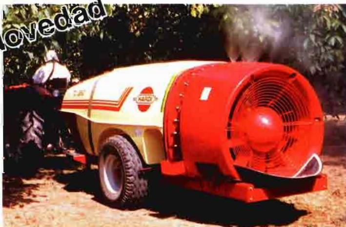
**TC-3092.** Atomizador de 3.000 l. con hélice de 920 mm.
