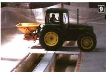
Foto 9. Ensayo de abonadora suspendida en la EECAS de Palencia.
