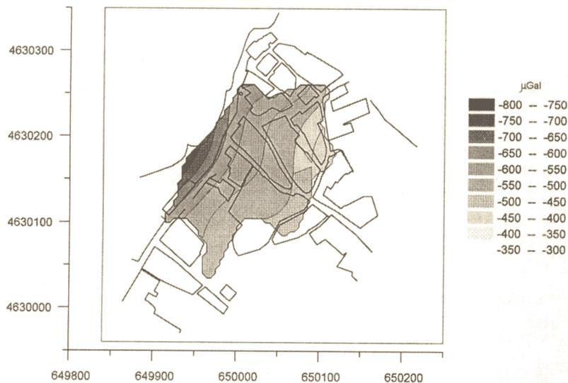
Figura 12. Campo regional de las anomalías gravimétricas obtenido mediante un ajuste polinomial robusto de sexto orden.
