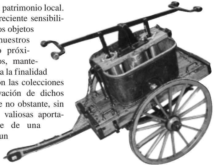
Fig. 4.- Bomba contra incendios fabricada en 1850 (Paris-Lyon).
