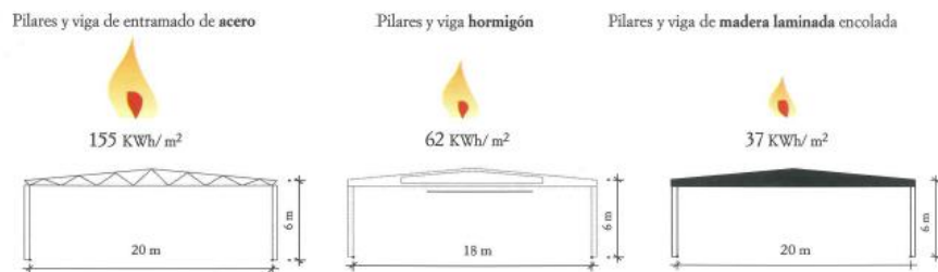
Figura nº 5. Comparación del consumo de energía primaria para la realización de una misma estructura de hormigón, acero o madera laminada (Kwh/m 2 cubiertos). (FUENTE: GAUTHIER, P.,2003)
