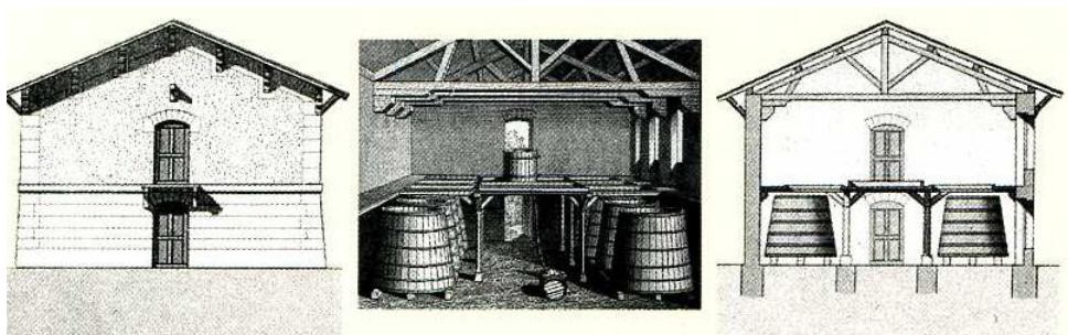
Figura nº 36. Esquemas de bodegas en la zona de Burdeos. (FUENTE: Exposición Centre Georges Pompidou: Chateaux Bordeaux. DETHIER, J. et al, 1988)
