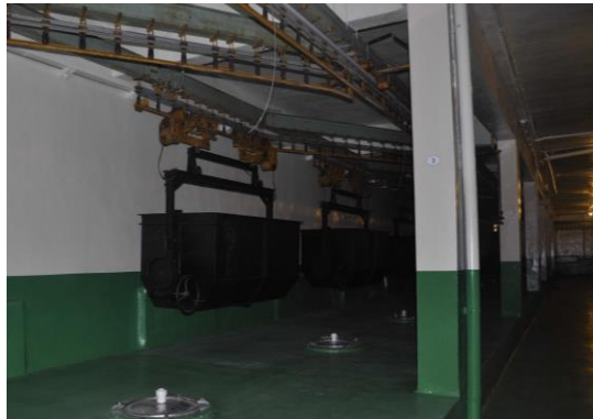
Figura nº 120. Fotografía de vagonetas de distribución de uva entera en cooperativa de San Vicente de La Sonsierra.
