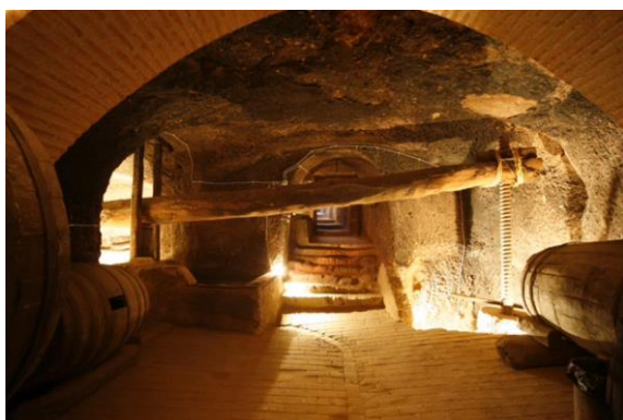
Figura nº 29. Prensa de viga y quintal en bodega de San Román de Hornija
