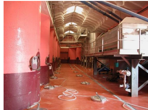
Figura nº 62. Foto de depósitos aéreos circulares en la que se observa las bocas superiores de los depósitos subterráneos situados en el pasillo en cooperativa de Tabuena (Zaragoza)
