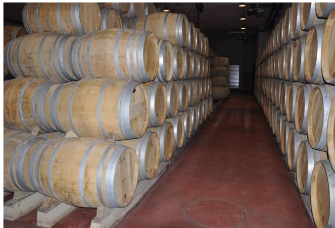
Figura nº 57. Apilado tradicional de barricas en Rioja. Máximo 5 alturas sobre durmientes y apoyos sobre cuñas de madera. Bodegas Viñedos del Contino (Laserna, Álava).
