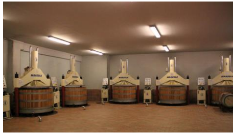
Figura nº 94. Prensas hidráulicas verticales de 20 hL en Bodegas Marqués de Riscal
