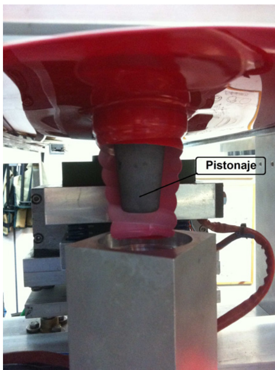
Fig. 6.48: Pistonaje en el proceso de termoformado.
