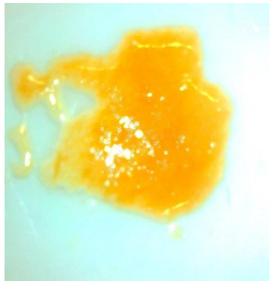
Figura 18: Tabla blanca de despiece que burbujea tras aplicar spray revelador a pesar de tener una apariencia visual limpia (véase en especial en los bordes de la aplicación)
