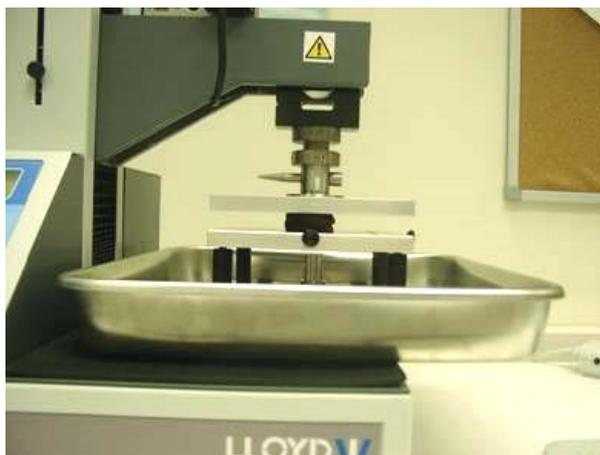
Figura 4.11. Primer ciclo de compresión-descompresión del análisis TPA
