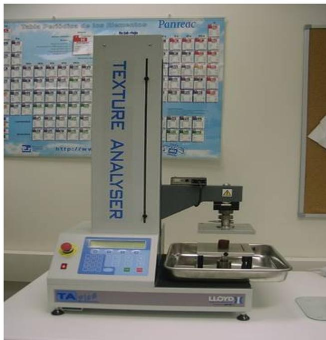
Figura 4.6. Analizador de textura modelo TaPlus de Lloyd Instruments utilizado para la realización de las medidas de las muestras de Chorizo Riojano
