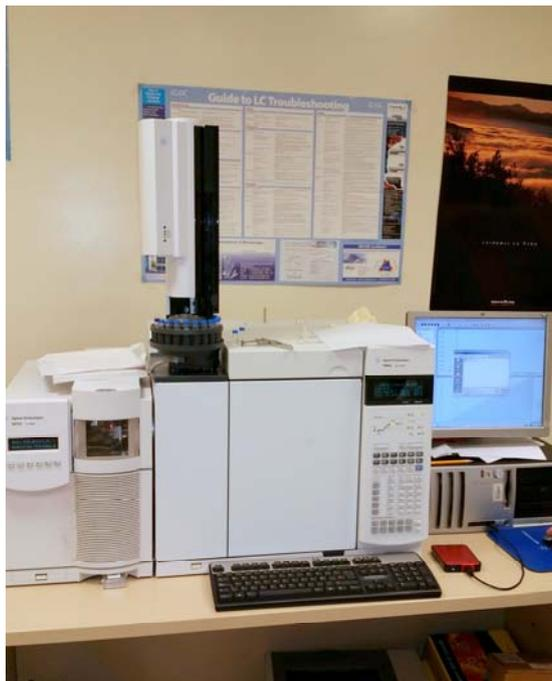
Figura 6.3. Cromatógrafo de GC-MS utilizado en el análisis de ácidos grasos en materias primas y Chorizo Riojano
