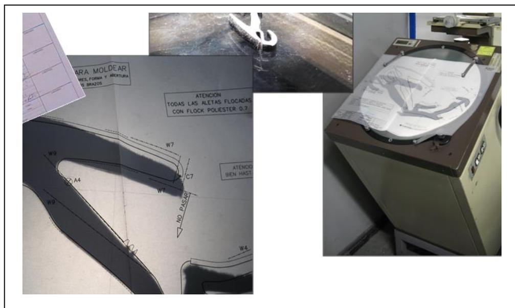
*Figura 8. Imagen del sistema tradicional de control seccional basado en un Proyector Óptico para la comprobación visual de las Secciones de Extrusión.*
