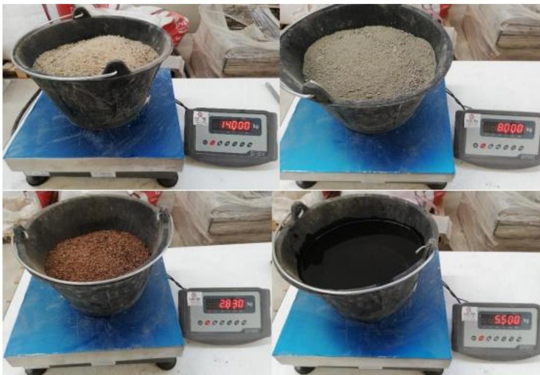
*Ilustración 17 – Ejemplo de proceso de pesaje de las cantidades necesarias para las probetas*
