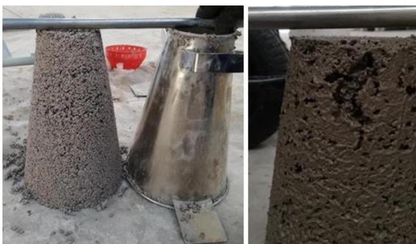
*Ilustración 20 – Ejemplo de realización del cono de Abrams*
