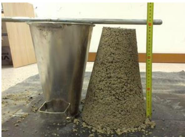
Ilustración 9 – Hundido de mortero en cono de Abrams
