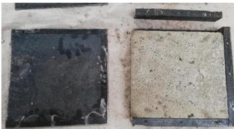
*Ilustración 24 - Ejemplo de extracción de las probetas*
