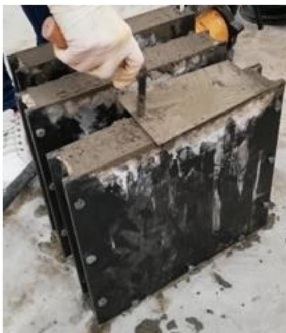
*Ilustración 22 - Ejemplo del llenado de las probetas*
