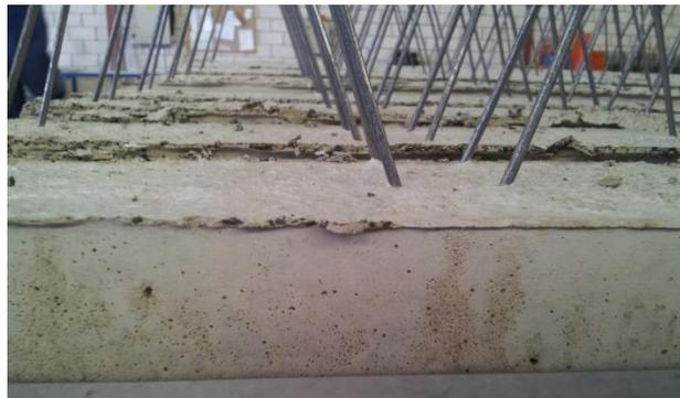
Ilustración 11 - Fabricación de viguetas en celosía con película de capa de caucho incorporada
