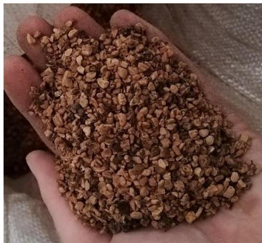
*Ilustración 15 – Triturado de hueso de oliva empleado en el dopaje de las probetas de mortero*
