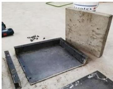
*Ilustración 25 - Ejemplo de extracción de las probetas completado*
