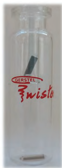
Figura 3.10. Vial de 20 mL con un Twister de PDMS por inmersión y otro de EG por espacio de cabeza.
