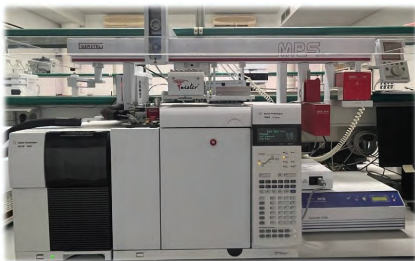
Figura 3.16. Cromatógrafo de gases (Agilent 7890A) acoplado a un espectrómetro de masas (Agilent 5975C).
