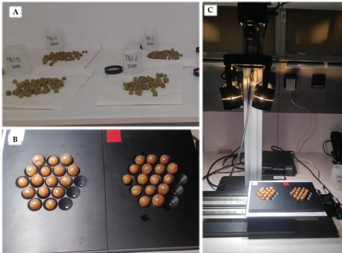
Figura 3.23. Proceso de adquisición de imágenes hiperespectrales. A) Muestras en el momento de descongelación y secado, B) porta muestras con una submuestra de 32 bayas, y C) adquisición de imagen hiperespectral de una submuestra.
