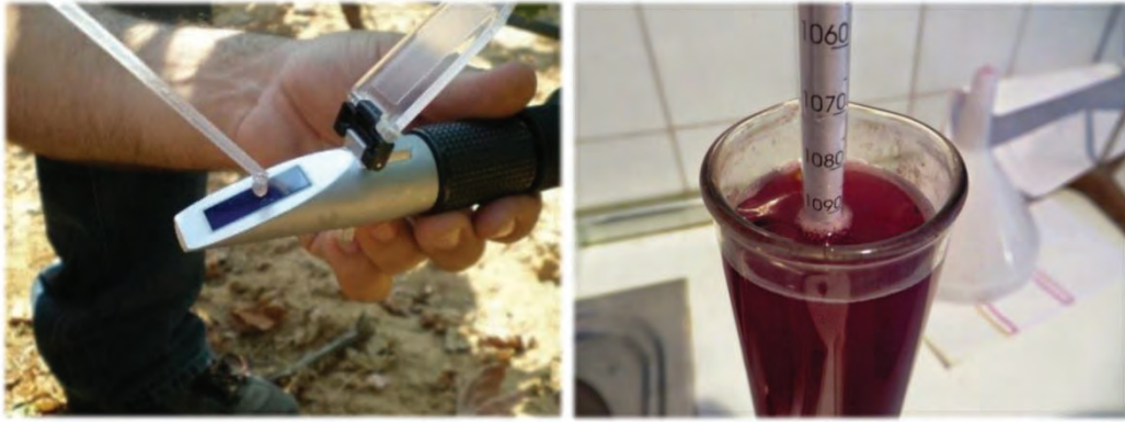
Figura 1.13. A) Refractómetro portátil para la medida de los sólidos solubles totales directamente en el viñedo. B) Medida de la densidad de un mosto en la bodega.
