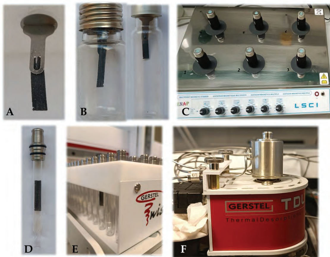
Figura 3.11. Esquema del proceso de extracción de compuestos volátiles mediante TF-SPME. A) TF en el inserto de metal, B) TFs colocadas en los viales de 10 mL (inmersión) y de 20 mL (espacio de cabeza), C) muestras colocadas en el agitador de 6 posiciones realizando la extracción, D) TF colocada dentro del tubo de desorción, E) tubo de desorción dentro de la bandeja de 98 posiciones del automuestreador y F) tubo de desorción dentro de la TDU.
