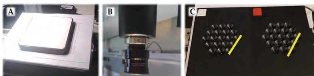
Figura 3.13. Partes de la cámara de imagen hiperespectral. A) Spectralon™, B) tapón para el objetivo, C) porta muestras.
