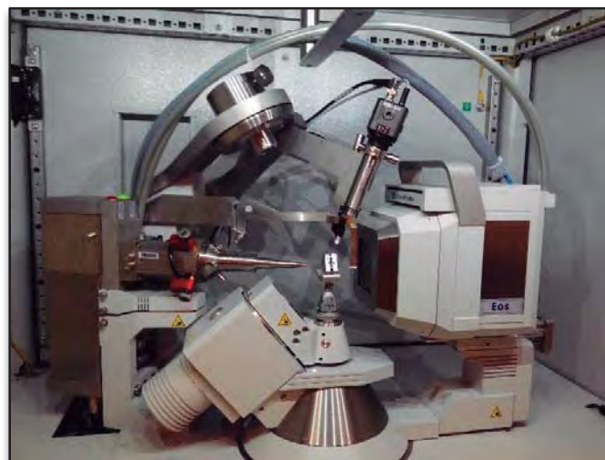
Figura 3.4.1. Difractómetro Rigaku SuperNova utilizado a lo largo de este estudio.
