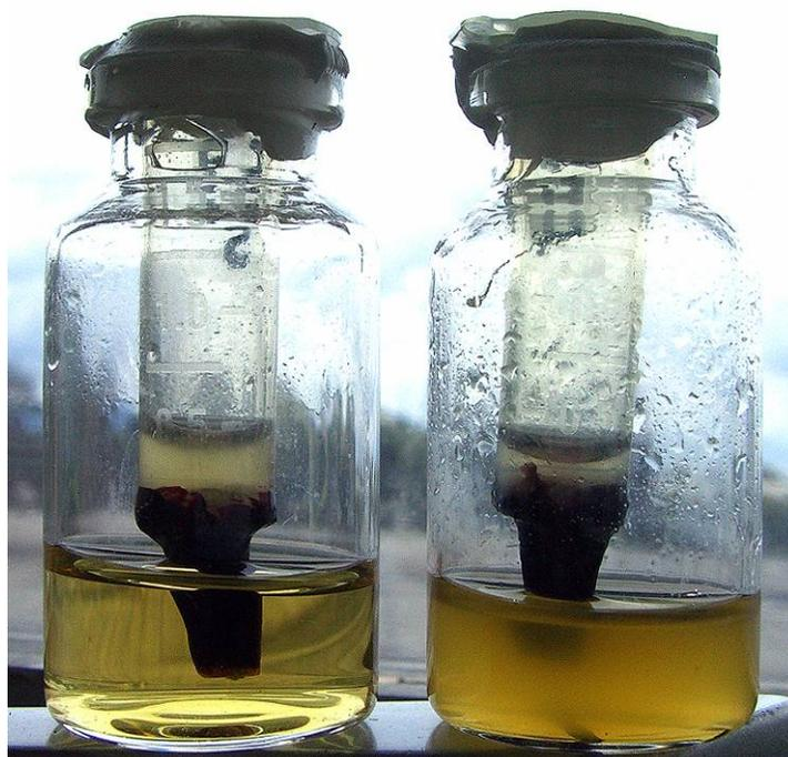
Figura 5.1 – Espécime microinfiltrado (direita) comparado a outro sem microinfiltração
