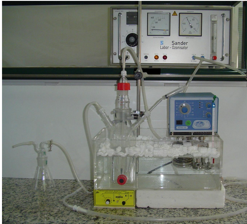
Figura 3.3. Instalación experimental para los ensayos de ozonización.
