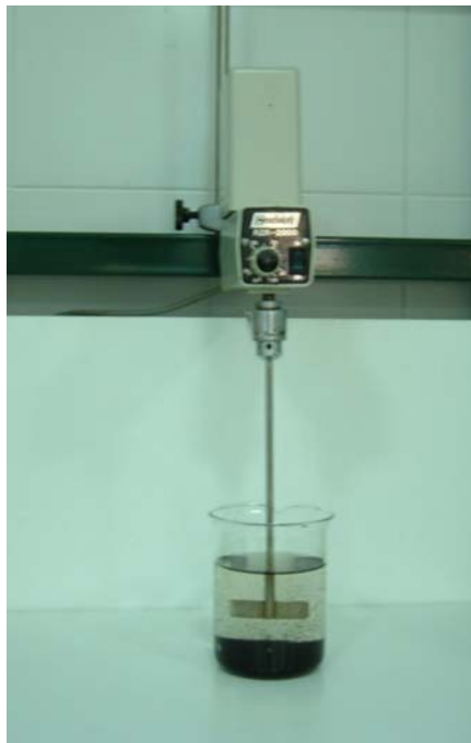
Figura 3.7. Instalación experimental para el estudio cinético de adsorción.
