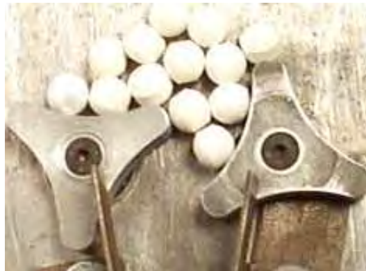
Figura 94. Diseño del sistema serializador de triángulos curvilíneos
