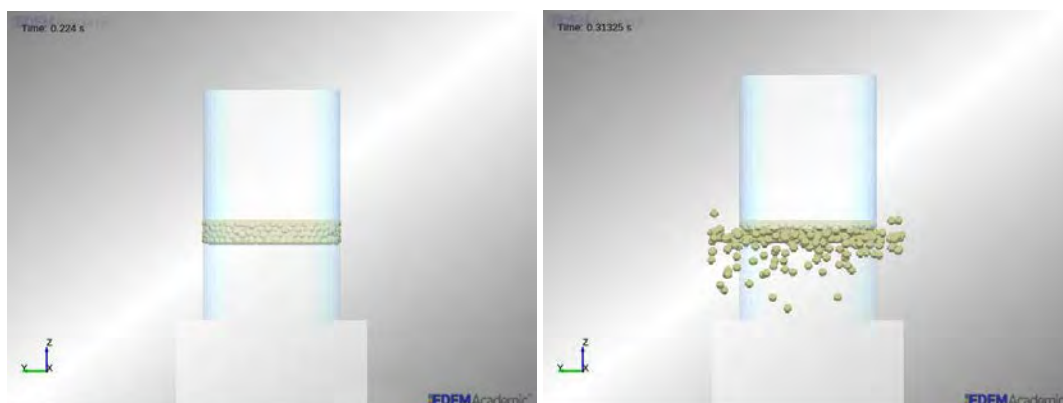
Figura 33. Efecto de la excesiva velocidad de compresión
