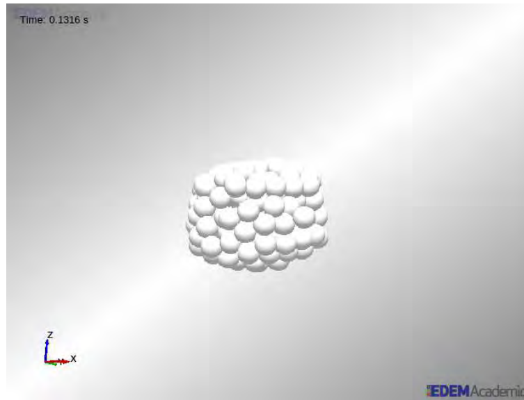
Figura 55. Modelo de comprimido obtenido para partícula de radio 1.5 mm
