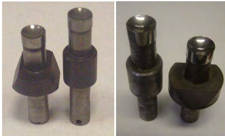
Figura 11. Punzones recubiertos de carburo de cromo (izq.) y tungsteno (dcha.)
