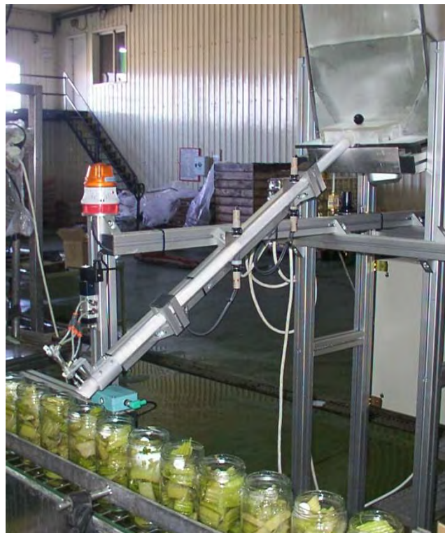
Figura 1. Sistema dosificador de aditivo alimentario comprimido
