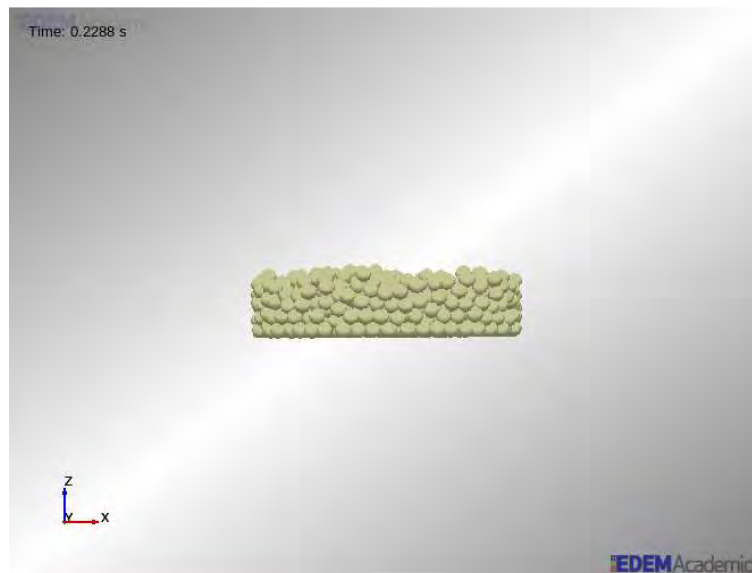
Figura 35. Módulo de corte 1 GPa. Comprimido (izq.) Fuerza de compresión (dcha.)
