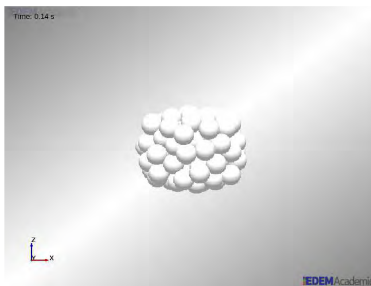
Figura 57. Modelo de comprimido obtenido para partícula de radio 1.75 mm
