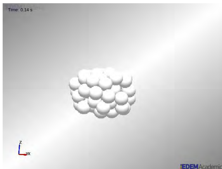
Figura 59. Modelo de comprimido obtenido para partícula de radio 2 mm
