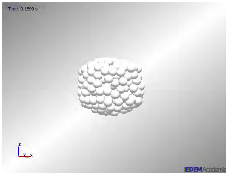
Figura 53. Modelo de comprimido obtenido para partícula de radio 1.25 mm
