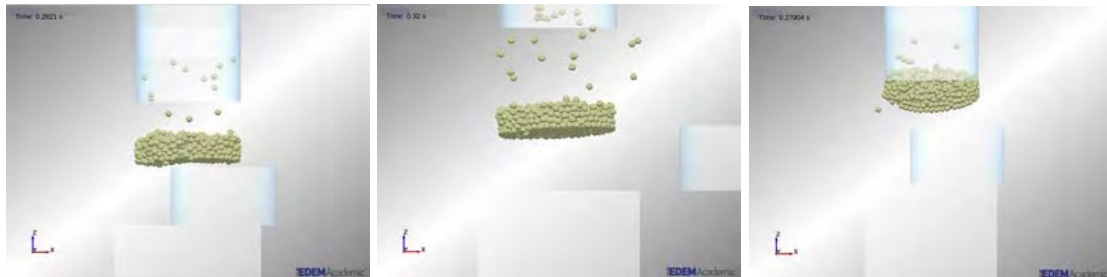
Figura 41. Comprimidos para valores de contacto: 100 MPa (izq.) 2.5 GPa (centro) y 2.9 GPa (dcha.)
