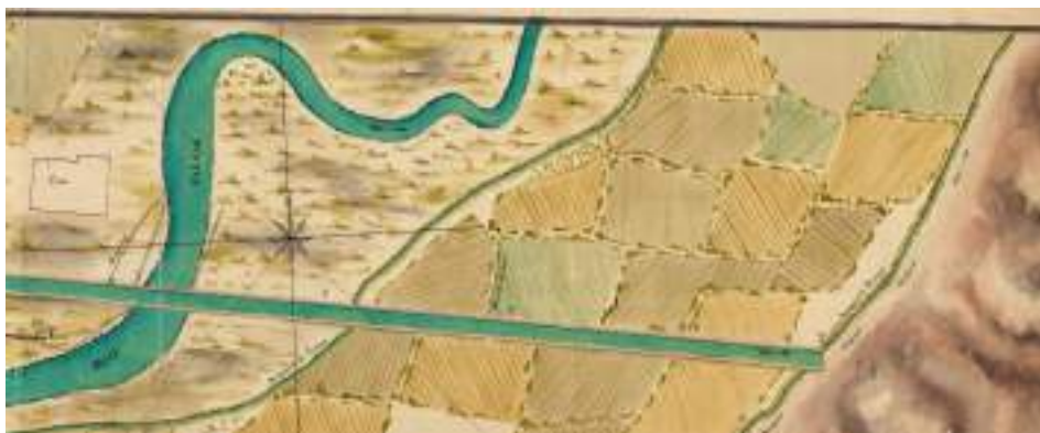
Figura 4. Detalle en el que se observa como la llamada Acequia Imperial y la acequia de Pinseque discurren unidas. Canal Imperial de Aragón a su paso por Grisén y Pinseque. Planos de Sebastián Rodolphe. Fuente: Obras Hidráulicas. Autor Gregorio Sevilla. Grisén, 18 de enero de 1773. Restaurado en el año 1999. M.I.T.M.A.
