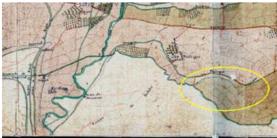
Figura 100: Ampliación de la imagen anterior donde se indica con un círculo amarillo el tramo de la acequia de Pinseque, el cual aparece también escrito, y paralelo a ella, en blanco y sin colorear, un ramal de acequia abandonada que por su forma y tamaño debe ser claramente identificada con el tramo actual de la Acequia Revieja.
