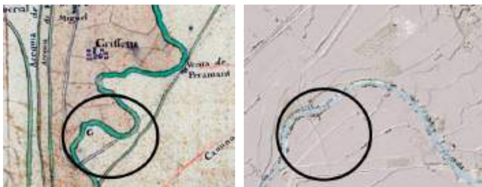
Figuras 44 y Figura 45: Comparativa del plano procedente del último cuarto del siglo XVIII con una imagen actual LIDAR que confirma lo anteriormente expuesto. Así, en donde lo que hoy es parte de la acequia de Pinseque, antaño fue tramo de la Acequia Imperial Vieja. Fuente: Cequia Imperial OH-605 B-BR. ACMITMA//Carreteras, caja 81910. Con la representación LIDAR se exhibe dicha zona donde se observa fosilizado tanto este trayecto como el tramo rectilíneo que descendía desde la localidad de Pedrola ubicado en la orilla izquierda del río Jalón. Fuente: https://www.ign.es/iberpixmap/visor/ .
