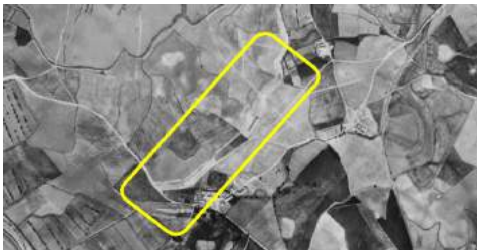
Figura 117. Evidencias todavía en superficie del tramo oculto de la Acequia Revieja mostrados bajo una apariencia difuminada obtenida a través del famoso Vuelo Americano serie B, llevado a cabo entre los años 1956 y 1957. Fuente: Centro de Descargas del CNIG del Instituto geográfico Nacional.
