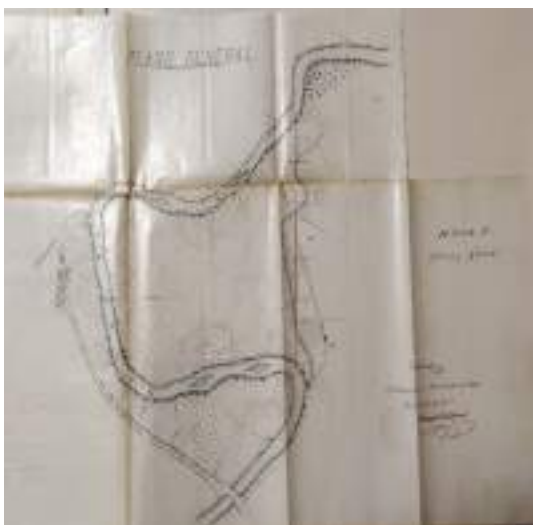
Figura 21 y Figura 22: Proyecto de rectificación y desvío del cauce del río Jalón en la inmediación de la localidad de Plasencia de Jalón, a escasos 5 kilómetros aguas arriba de Bárboles. Junto a este, plano general donde se muestra el mismo cauce a su paso por la localidad de Plasencia de Jalón. Año 1889. Fuente: Archivo Ayuntamiento de Bardallur.
