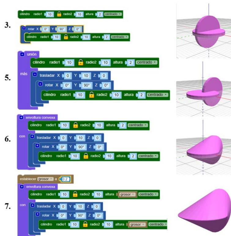
Figura 5.6: Pasos del proceso de creación del oloide en BlocksCAD
