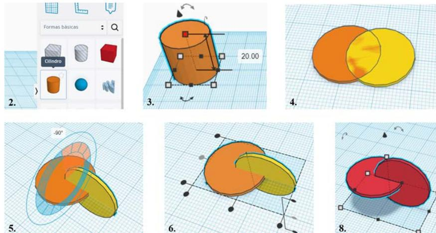
Figura 5.3: Pasos del proceso de la modelización de los círculos generadores del oloide en Tinkercad
