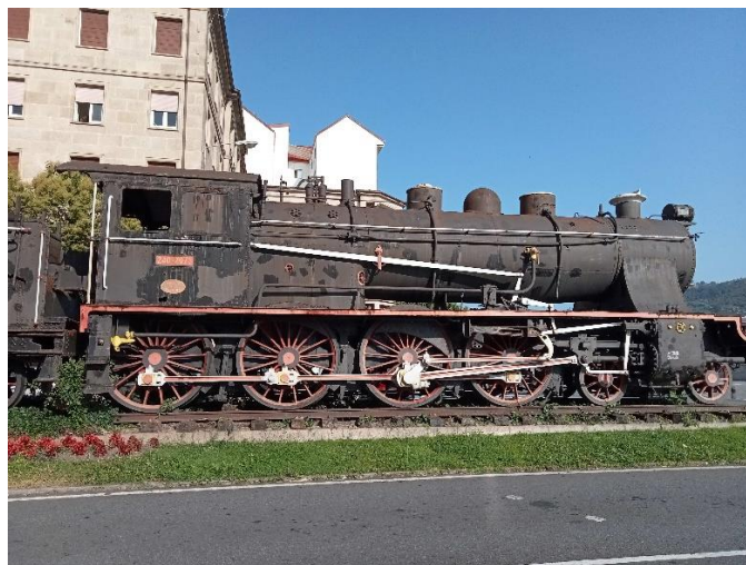
Figura 4: Vista de la locomotora y de su rodaje. 2 ejes portadores delanteros y 4 ejes motores, dotados de sus correspondientes bielas y engranajes (Fotografía del autor).
