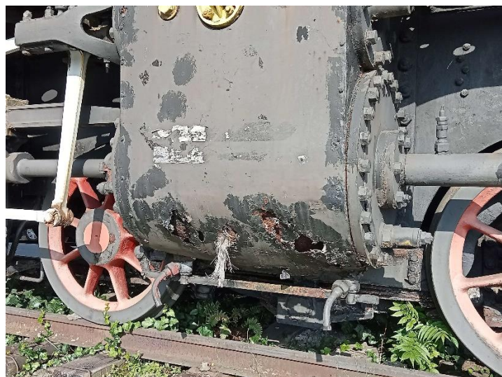
Figura 9: Estado de una de las cajas de válvulas de la locomotora, situada entre los ejes portadores delanteros (lado derecho de la máquina). Fotografía del autor.
