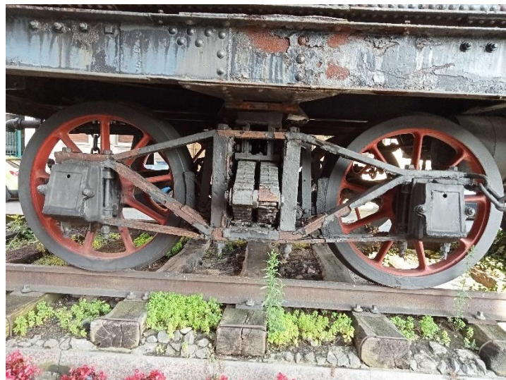
Figura 14: Estado del chasis, sistemas de suspensión, engranajes y rodajes del tender, también muy deteriorados por el paso del tiempo y la falta de conservación y mantenimiento. Fotografía del autor.
