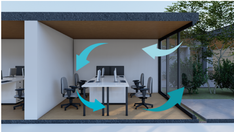
Figura 63. Ventilación unilateral Fuente [elaboración propia]
