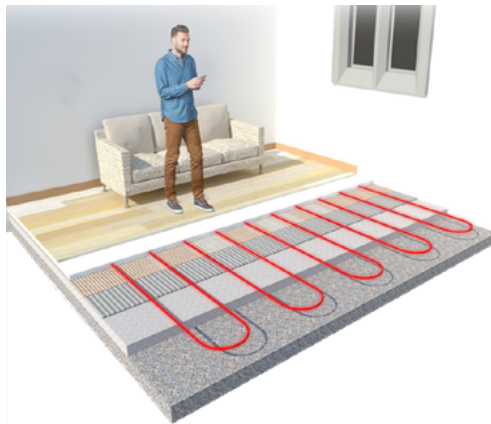
Figura 26. Losa radiante en sala de estar Fuente [elaboración propia]
