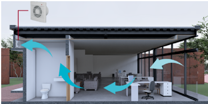
Figura 67. Ventilación por depresión Fuente [elaboración propia]
