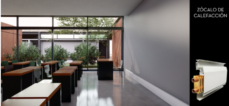
Figura 28. Calefacción por zócalos Fuente [elaboración propia]
