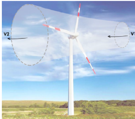
Figura 70. Flujo de viento a través de turbina eólica Fuente [elaboración propia]
