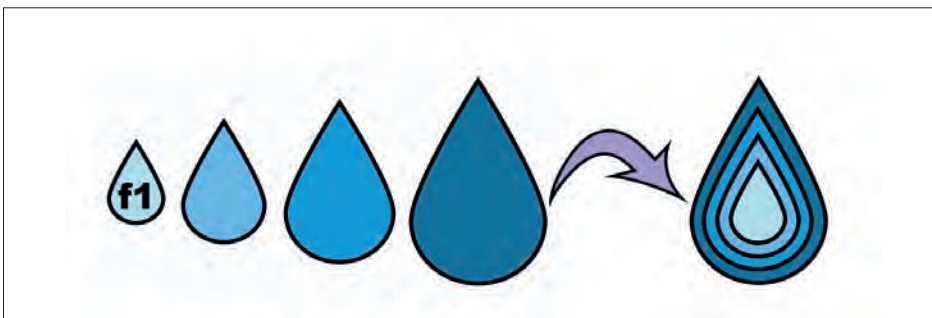
Fig. B.4: Ejemplo del movimiento asimétrico por homotecia. La celda base es f1 y se aumenta de forma proporcional su tamaño para obtener la figura final.
