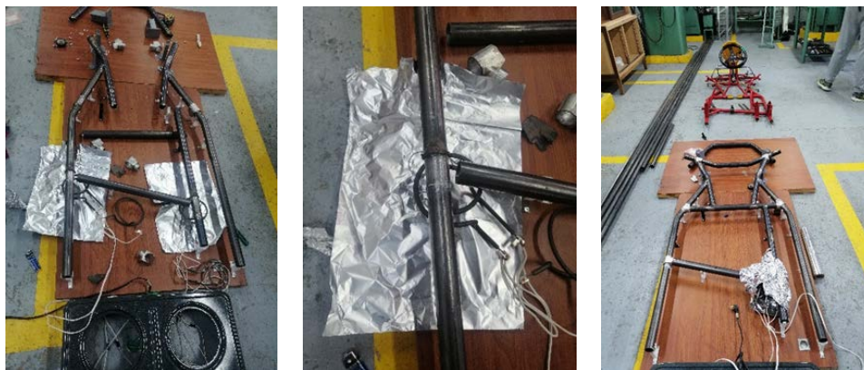
Figura 18. Proceso de curado de las uniones adhesiva integradas al prototipo del chasis go kart . Con ayuda de la matriz de soldadura se garantiza posiciones y como fuente de calor para el curado de las uniones se utilizan resistencias eléctricas controlando la temperatura constante de 80°C
