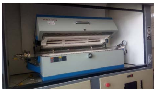
Figura 4. Horno horizontal de tres etapas con reactor de cuarzo
