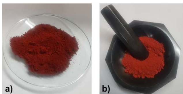
Figura 2. a) Polvo de hematita con tamaño de partícula de orden micrométrico, y b) Mortero y pilón de ágata empleados para pulverizar el polvo de hematita
