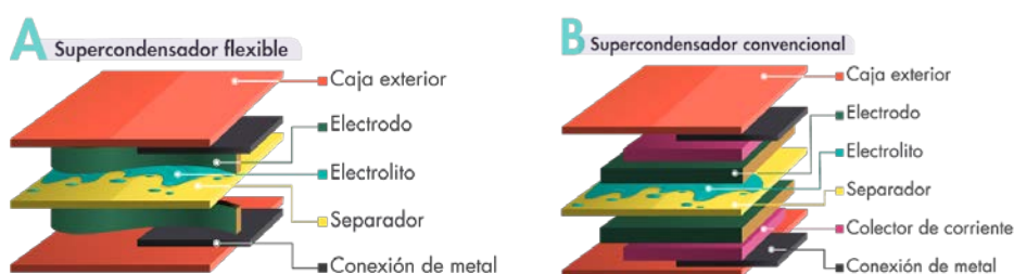
Figura 2. Representación gráfica de un supercondensador: a) flexible, y b) convencional [13]
