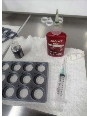
Figura 7. Proceso de ensamble de las probetas. Se requiere de un espacio limpio, una jeringa para medir y tener control del volumen de adhesivo, es empleado el adhesivo anaeróbico comercial de la referencia Loctite 648
