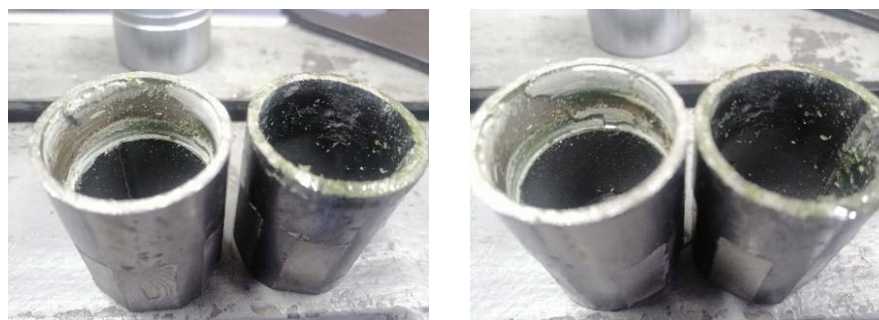
Figura 11. Resultados ensayo a torsión. Los sustratos hembra material tubería estructural acero fue donde el adhesivo cubrió mayor área de adhesión, hay presencia de polvillo debido a que el adhesivo al curarse se solidifica formando un solo solido con los sustratos a unir, y al llevarse a fractura lo que falla es el adhesivo, por eso es considerado a las uniones adhesivas como un fusible mecánico en la estructura
