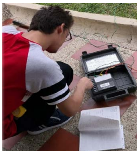
Figura 4. Toma de Datos con el Telurómetro
