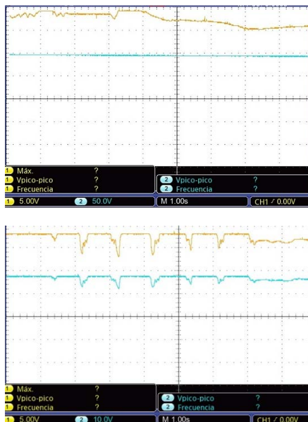
Figura 9. Voltajes de entrada y salida: A) circuito abierto, B) con carga de 1000\Omega
