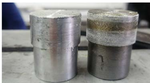
Figura 10. Resultados ensayo a torsión. Tenemos los dos sustratos machos del ensamble, se puede evidenciar como el adhesivo presenta mayor adherencia en el sustrato de material acero (derecha) y poca adherencia en el sustrato de material duraluminio (izquierda)
