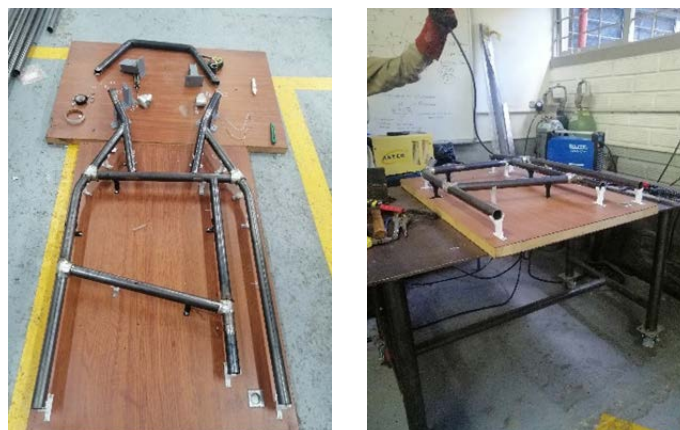
Figura 19. Proceso de soldadura para componentes del prototipo de chasis del vehículo monoplaza serie kart
