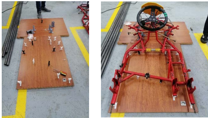
Figura 16. Construcción de una matriz de soldadura. Como base se utiliza madera y los soportes son impresos en 3D con material PLA, tomando como referencia el chasis de un vehículo kart comercial
