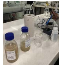
Medición de pH de CM pasteurizado. Valores: 3.316 - 3.422
