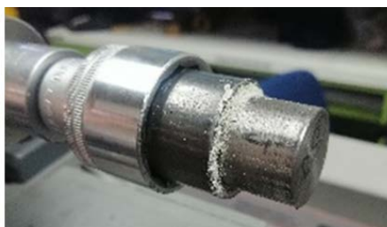
Figura 9. Resultados ensayo a torsión. Las probetas se someten a una carga fija 40 Nm a torsión llevando a la falla, y se puede evidenciar que el adhesivo una vez se fractura se convierte en polvillo blanco
