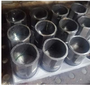
Figura 8. Proceso de curado de las probetas. Se utiliza un horno eléctrico, se controla la temperatura de 80°C por una (1) hora, y luego se deja en reposo por 24 horas a temperatura ambiente
