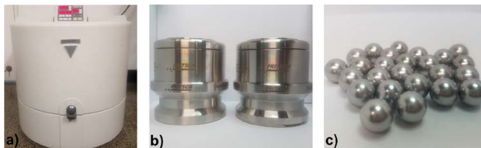
Figura 4. a) Molino planetario Fritsch Pulverisette 5 empleado en la molienda mecánica del material \alpha\text{-Fe}_2\text{O}_3 . En el proceso de molienda se utilizaron: b) jarros, y c) bolas de acero inoxidable
