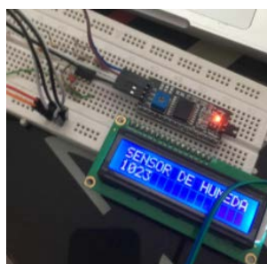
Figura 15. Comunicación entre Microcontrolador, sensor de humedad y pantalla LCD
