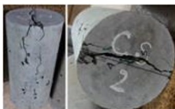
Figura 28. Fisuras de cilindros en concreto convencional
