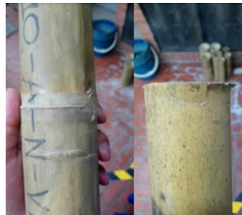
Figura 3. Falla en las probetas de Guadua en el ensayo a Compresión
