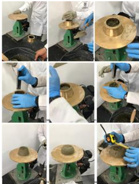
Figura 10. Ensayo de fluidez mediante mesa de flujo. En las imágenes mostradas se puede observar el ensayo de fluidez desde la colocación de la muestra en el molde, los golpes de compactación y la medición del diámetro expandido al final del ensayo
