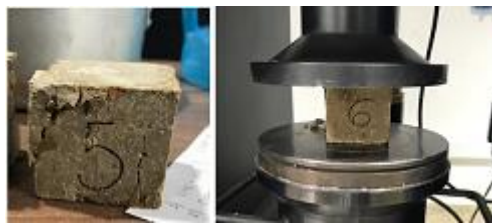
Figura 9. Falla de los especímenes 5 y 6 con cascaras de huevo
