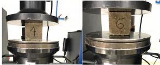
Figura 6. Especímenes sometidos al ensayo de compresión mediante la maquina universal
