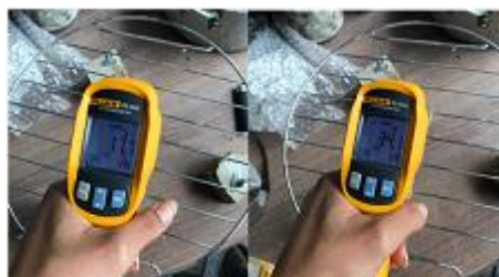
Figura 11. Ensayo de temperatura. En la imagen de la izquierda se muestra la temperatura superficial de la muestra de mortero con cascaras de huevo antes del ensayo y a la derecha la temperatura alcanzada después de 1 minuto en la misma muestra ensayada. Ambas temperaturas están expresadas en grados Celsius
