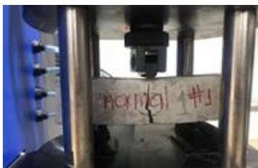
Figura 17. Falla del paralelepípedo 2 de la mezcla tradicional en el ensayo a flexión
