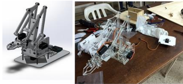
Figura 5. Diseño 3D (Piezas en contacto que forman el 1 er grado de libertad) y versión física en acrílico del prototipo 1
