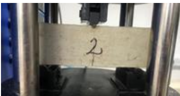
Figura 14. Falla del paralelepípedo 2 con cascara de huevo en el ensayo a flexión
