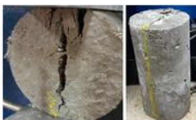
Figura 29. Fisuras concreto con 1% de adición de fibras de vidrio
