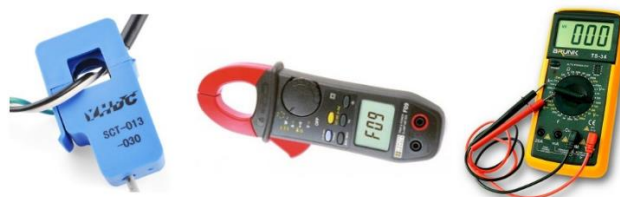
Figura 8. Sensor, Pinza Amperimétrica, Multímetro
