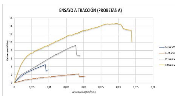
Figura 11. Ensayo a tracción (Probetas A, diámetro de 5 centímetros)
