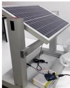
Figura 4. Panel solar de 20W en base
