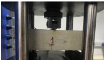
Figura 13. Falla del paralelepípedo 1 con cascara de huevo en el ensayo a flexión
