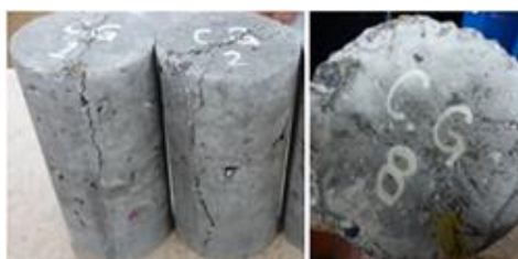
Figura 30. Fisuras concreto con 1% de adición de fibras de guadua
