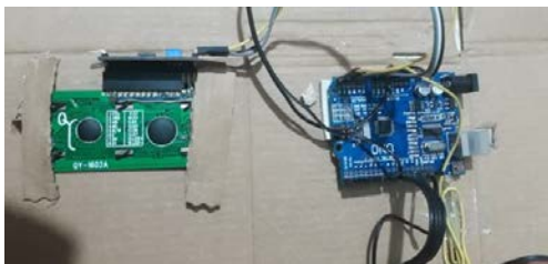
Figura 8. Conexión Arduino a pantalla Liquid Crystal Display (LCD)
