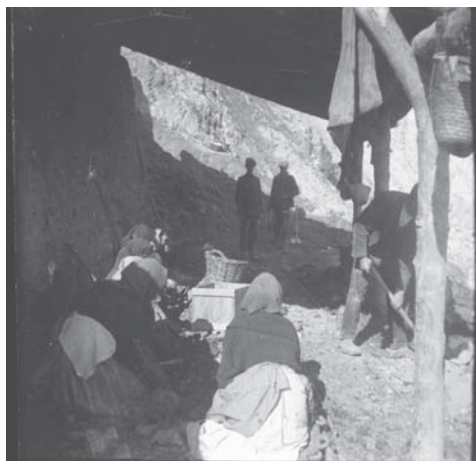
Grupo de mujeres trabajando en el estrío, es decir, seleccionando los mejores minerales de plomo, en las inmediaciones de la mina “Triunfo” de Mazarrón.
