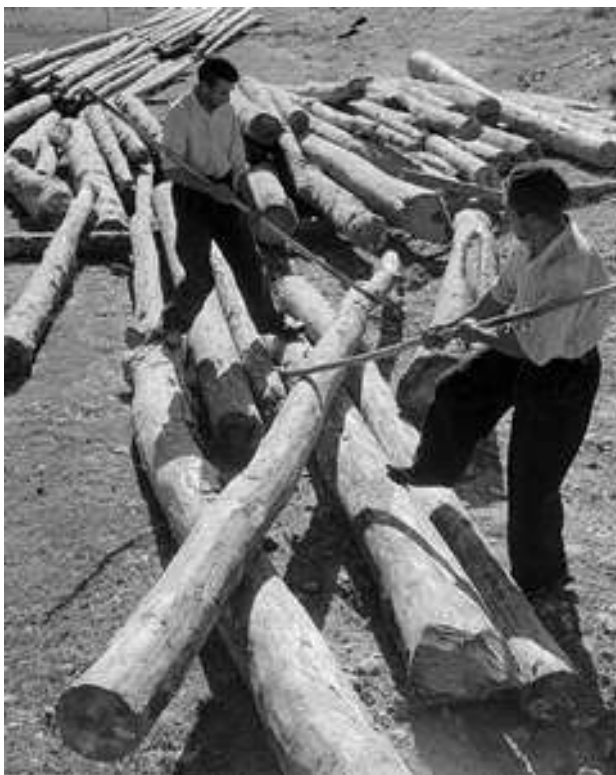
Fig 6. Navateros del Sobrarbe reuniendo los troncos para formar los «tramos» de una navata.
