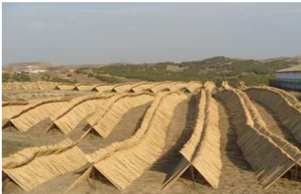
Fig 25. Secadero de cañas en Urrea de Gaén (TE) con las que elaboran lengüetas para instrumentos musicales. 2019.
