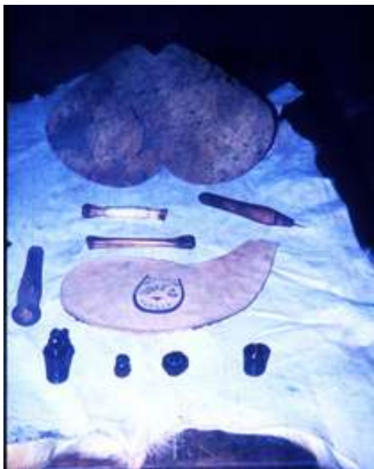
Fig 7. Plantilla, útiles y partes del tapón de una bota. Botería Ubieta de Huesca. Julio 1977.
