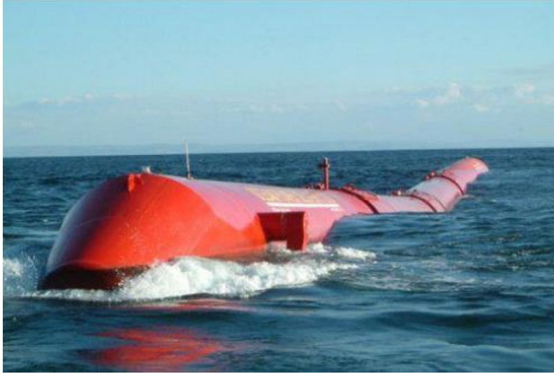
Ilustración 17. Aspecto de la tecnología PELAMIS en pleno funcionamiento ( www.pelamiswave.com )
