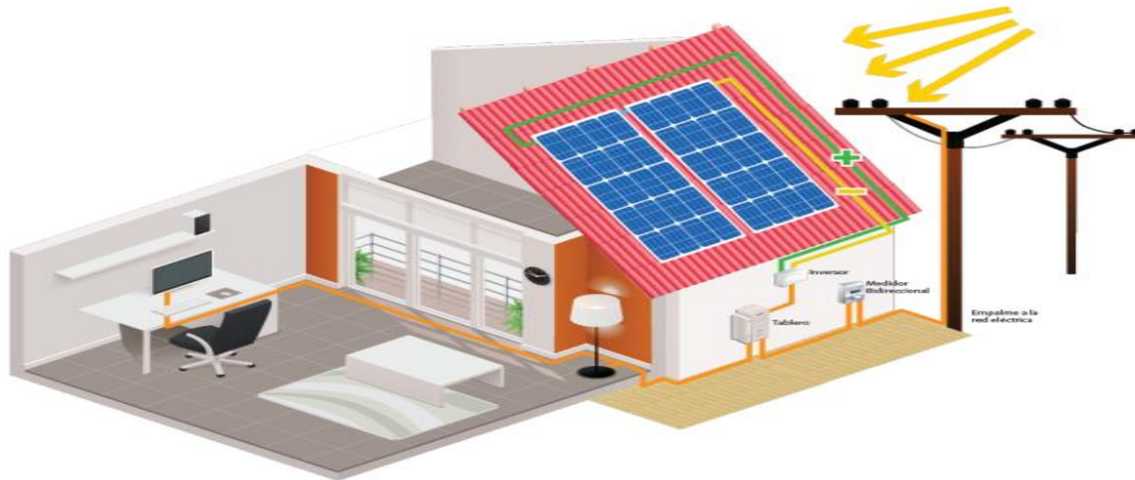
Ilustración 2. Componentes de un sistema fotovoltaico (ACESOL)
