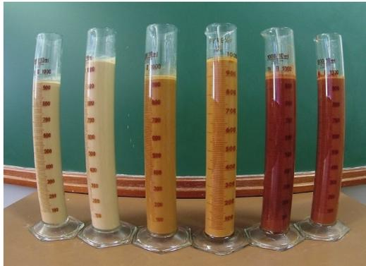
Fig. 3: Ensayos para la evaluación de estabilidad de las suspensiones de pigmentos. Fuente: Archivo del proyecto "Cores da Terra".
