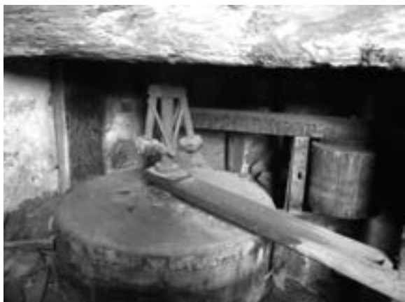
Fotografía y dibujo de las revoladeras del Molino de El Calvario (Garafía, La Palma) [ALT]
