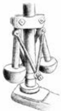
Fotografía y dibujo de las revoladeras del Molino de El Calvario (Garafía, La Palma) [ALT]
