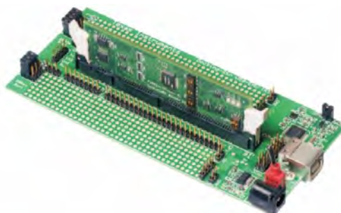
Figura 1. Plataforma “delfino c2000 kit”, sistema de desarrollo para el DSP TMS320F28335 del fabricante Texas Instruments.
