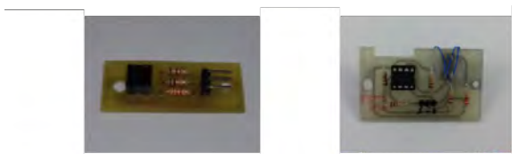
Fig 8. PCB de adaptación de los sensores CNY70 y TCST1103 diseñados
