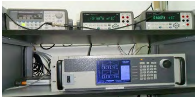
Figura 3. Sistema trazador de curvas I - V basado en fuentes de cuatro cuadrantes instalado en la Universidad de Málaga.
