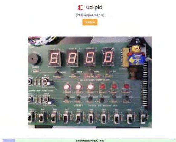
Fig. 11. Proceso de síntesis del decodificador BCD-7 segmentos en VHDL
