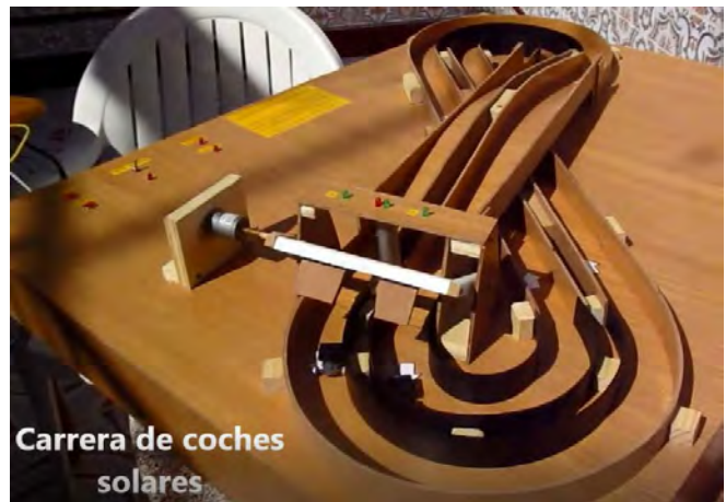
Fig. 9. TFG basado en el diseño de un circuito de carreras de coches fotovoltaicos. Realizado en marquetería, con la electrónica oculta en su interior, tiene la posibilidad de funcionamiento autónomo analógico o digital con envío de información de las carreras vía web.
