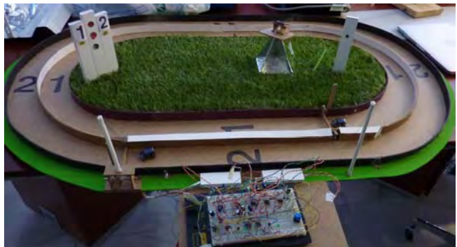
Fig. 7. Diseño Global del Circuito. Circuito oval que contaba con un sensor solar para indicar si las condiciones eran óptimas para la carrera.
