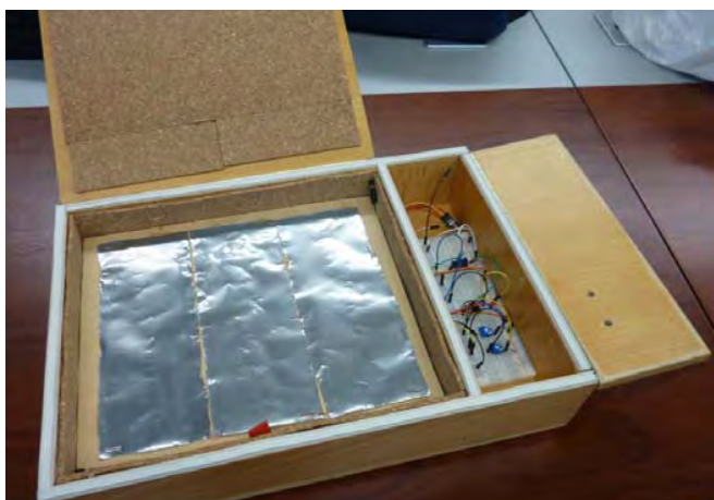
Fig. 4. Diseño Global de la Incubadora de muestras. Prototipo basado en un diseño propio con mejora de aislamiento, elemento calefactor basado en resistencias de potencia e interfaz con botones y diodos leds.
