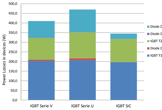
Fig. 15. Distribución de las pérdidas de potencia [W] en los diferentes dispositivos (T1, D1, T2, D2, D5) de la topología 3L-NPC.
