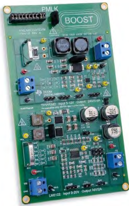
Fig. 3. Placa experimentació de Texas Instruments TI-PMLK Boost Experiment Board (TPS55340 & LM5122)
