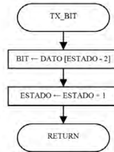
Fig. 17. Diagrama de flujo de una rutina de acción que puede ser reutilizada en diferentes estados.
