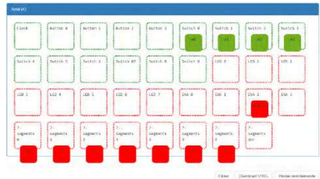
Fig. 8. Asignación de pines de entrada y salida del decodificador BCD-7 segmentos
