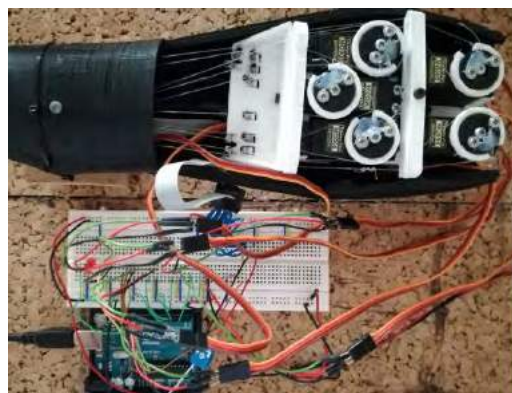
Fig. 5. Detalle de los diferentes servos, cables y muelles destinados al accionamiento de cada uno de los dedos y muñeca. El control de la prótesis es realizado por medio del controlador Arduino, quien proporciona la señal PWM para el accionamiento de los diferentes elementos.
