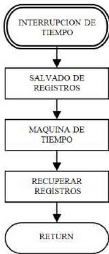
Fig. 5. La máquina de tiempo se ubica en la rutina de atención de interrupciones del temporizador.
