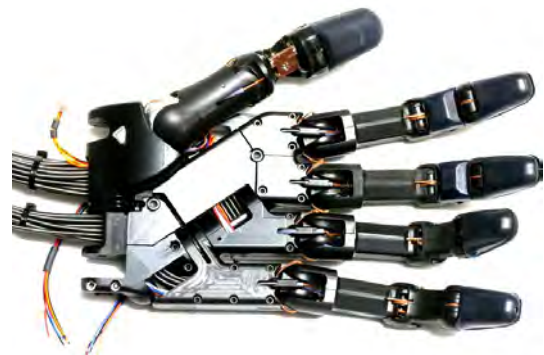
Fig. 1. Ejemplo de una prótesis biónica controlada mediante una plataforma embedded (Arduino Uno).
