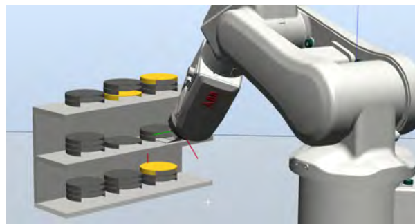
Fig. 3. Almacén automático en entorno de desarrollo y simulación RobotStudio.
