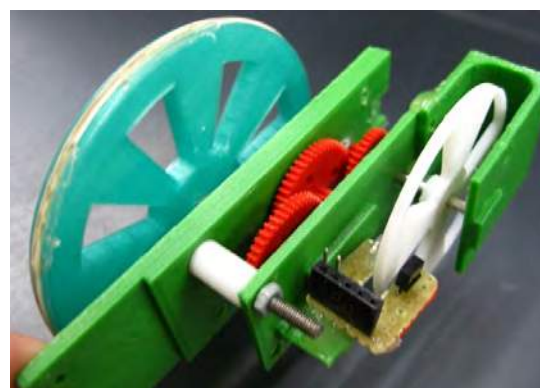
Figura 5: Encoder diseñado con piezas de impresión 3D
