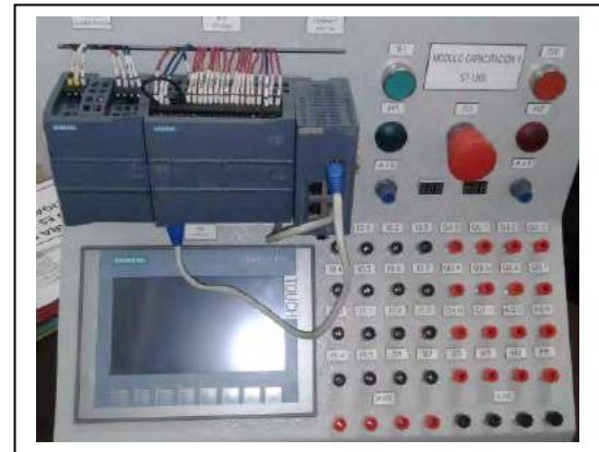
Fig. 7. Módulos de capacitación diseñados por la coordinación de Ingeniería electrónica Universidad ECCI.
