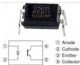
Figura 3. Optoacoplador PC817 utilizado para la medida de tensiones.
