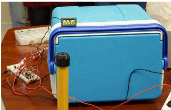
Fig. 2. Diseño Global de la Incubadora de muestras. Prototipo basado en una nevera portátil comercial con mejora de aislamiento e interfaz con display.
