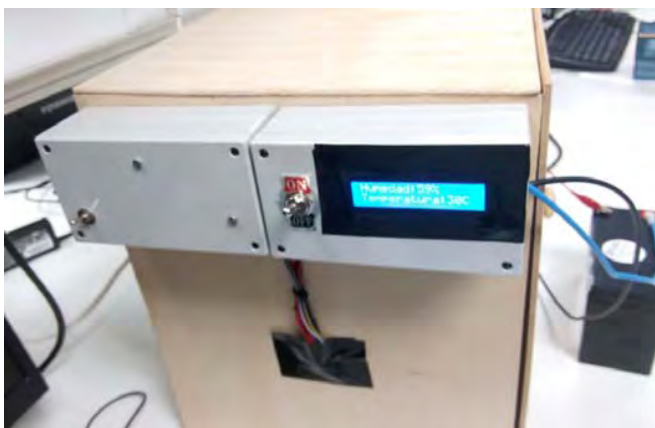
Fig. 10. TFG basado en el diseño de una incubadora de muestras microbiológicas de bajo coste. Se apuesta por un diseño propio de marquetería y poliestireno para un aislamiento térmico optimizado.
