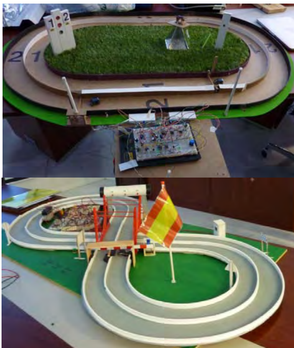
Fig. 6: Detalle de algunos de los circuitos de carreras para coches fotovoltaicos presentados.
