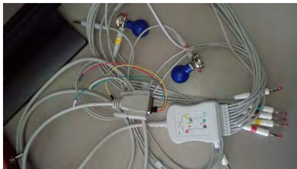
Figura 4. Cable tipo Schiller utilizado para el transporte de señales.
