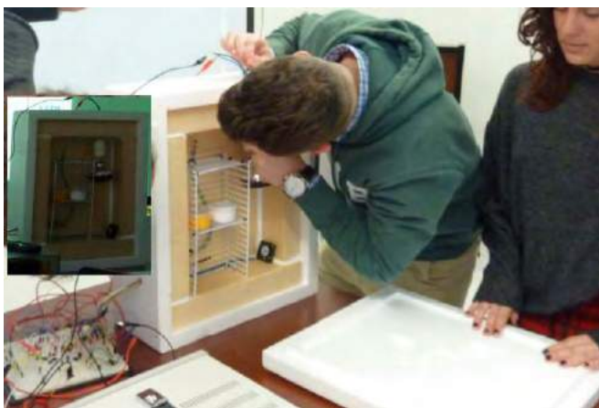
Fig. 3. Diseño Global de la Incubadora de muestras. Prototipo basado en una nevera portátil comercial con mejora de aislamiento, y ventilación forzada.
