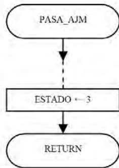
Fig. 12. El cambio de estado se realiza en las acciones.
