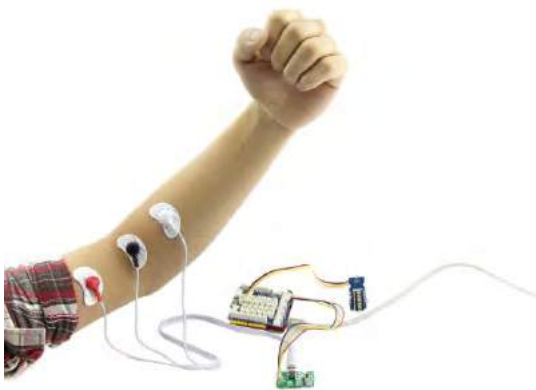
Fig. 2. Ejemplo de sensor EMG/ECG superficial utilizado para el control de la prótesis robótica. El sistema incluye los electrodos y la etapa analógica de instrumentación en modo diferencial.
