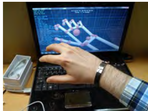
Fig. 4. En el interface de usuario pueden apreciarse las diferentes variables proporcionadas por el dispositivo Leap Motion. Los parámetros relativos a la posición de los distintos elementos son gestionados por sistema de control.
