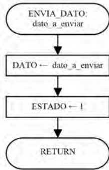
Fig. 15. Activación de la máquina de estados de evento único por rutina en el lazo principal.
