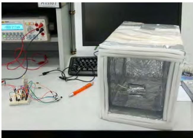
Fig. 5. Diseño Global de la Incubadora de muestras. Desarrollo de un prototipo basado en un diseño propio con mejora de aislamiento, elemento calefactor basado en resistencias de potencia e interfaz con botones y diodos leds
