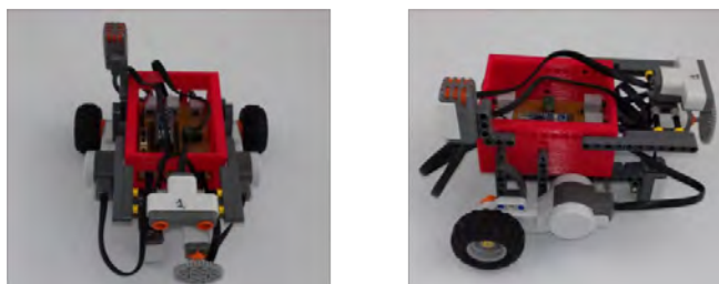
Fig 14. Vista frontal y lateral del Robot B donde se observa el recubrimiento estructural de la tarjeta de control impreso en 3D
