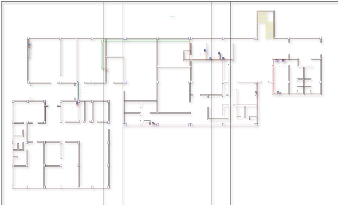
**Ilustración 6.** Canalización de Puntos de Red Primer Piso.
