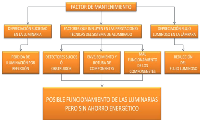
Figura 3.4: Factores que intervienen en una mala gestión de mantenimiento. Fuente: elaboración propia.
