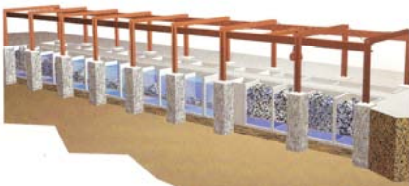
Detalle del antiguo cárcamo y del sistema hidráulico de válvulas de piso y aéreas del viejo tanque saturador. (Archivo Oscar Monsalve Pino, 2000)
