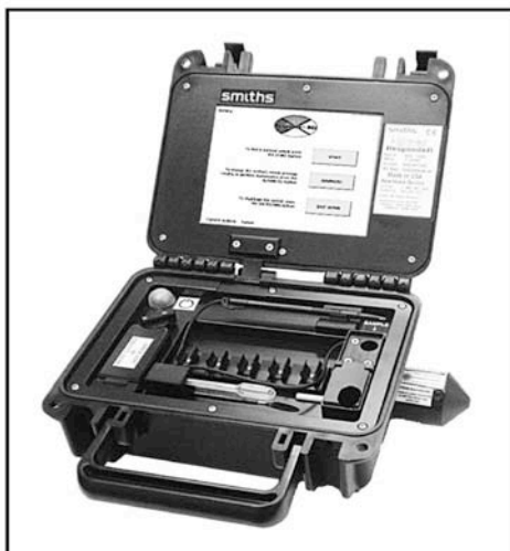
Figura 7. — Espectrómetro Raman portátil Responder RCI, de Smiths Detection.
