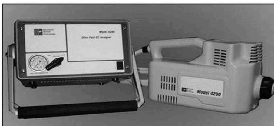
Figura 19.— Sistema de detección EST-4200 Ultimate Vapor Tracer & Analyzer, de Electronic Sensor Technology que utiliza un cromatógrafo de gases de alta temperatura con detector SAW.
