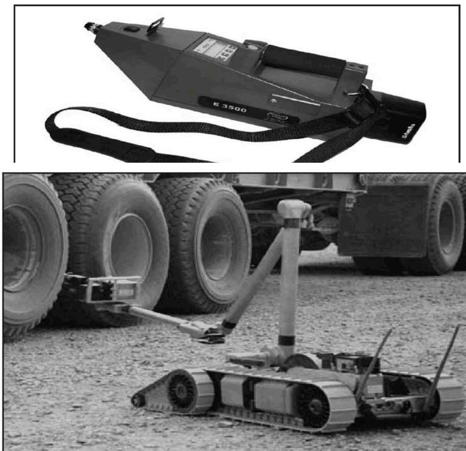
Figura 21. — Detector por quimioluminiscencia Fido® OnBoard de ICx Technologies, Inc., montado en un robot.
