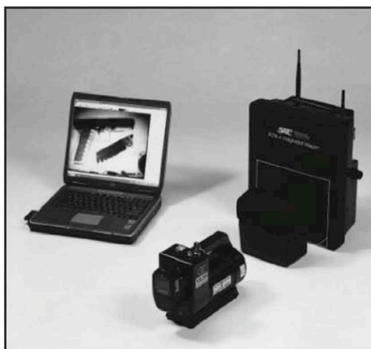
Figura 27.— Sistema portátil de imagen de rayos X RTR-4® de SAIC.
