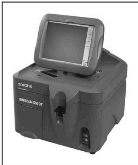
Figura 13. — Aparato fijo IONSCAN 500DT de Smiths Detection.
