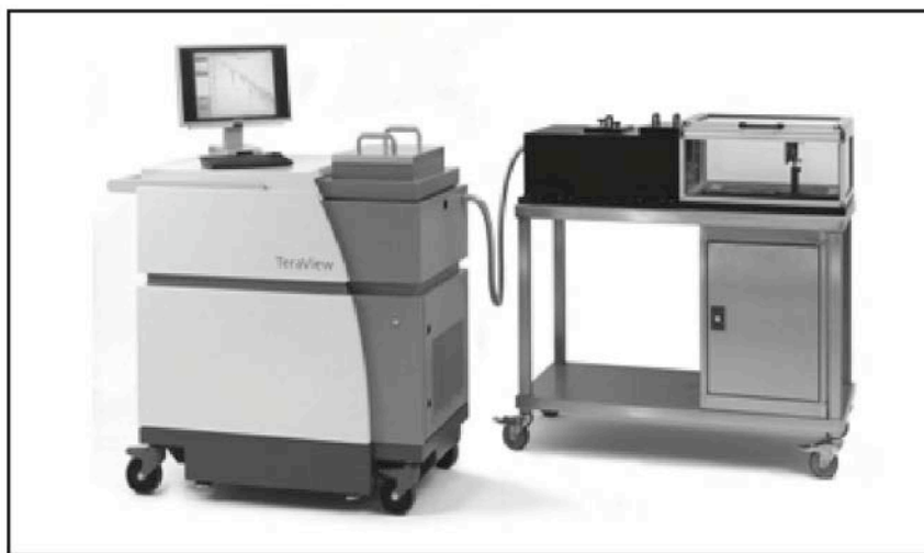
Figura 32.— Sistema de detección de explosivos basado en el TPS spectra 3000, espectrómetro pulsado de terahercios de TeraView.
