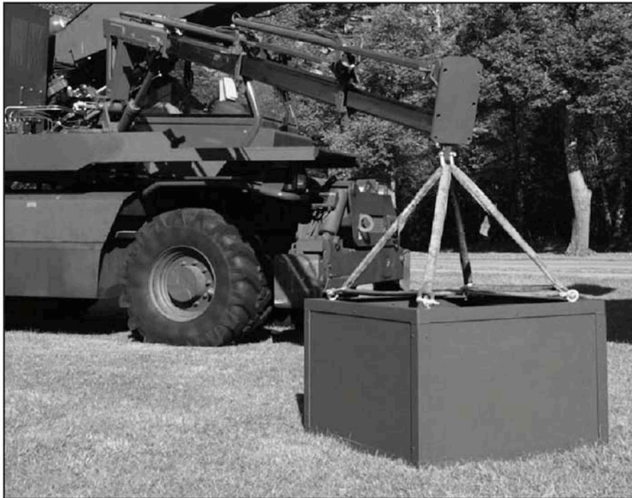
Figura 25.— Sensor desplegado sobre el terreno en aplicaciones de detección de minas por detección empleando neutrones. Cortesía de EADS.
