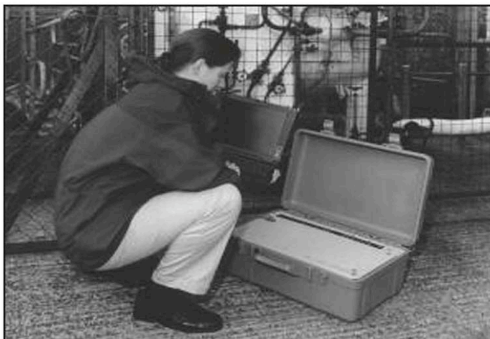
Figura 16.— Espectrómetro de masas portátil, con tecnología TOF, MS-200 de Kore Technology.
