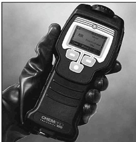
Figura 14. — Detector portátil por IMS ChemPro100i de EnviroNics.
