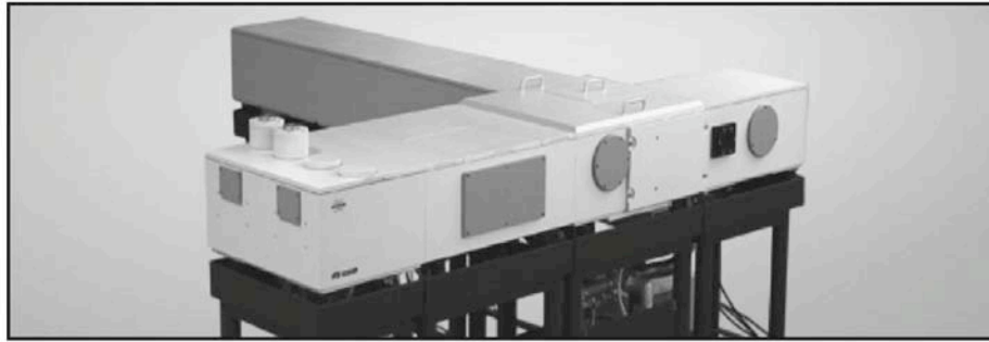
Figura 9. — Espectrómetro FTIR de alta capacidad para uso en laboratorio IFS 125, de Bruker Optics.
