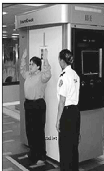
Figura 28.— Sistema SECURE 1000, de Spectrum San Diego, Inc., que utiliza Rayos X retrodispersados.
