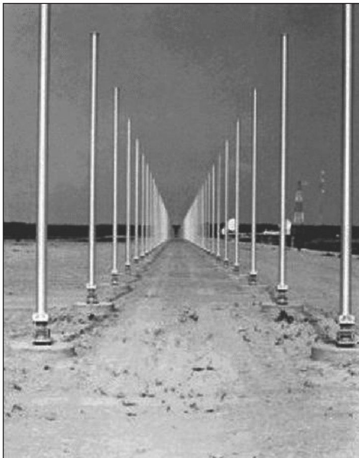
Figura 1.- Sistema de antenas del sistema relocizable AN/TPS-71 (US Navy).
