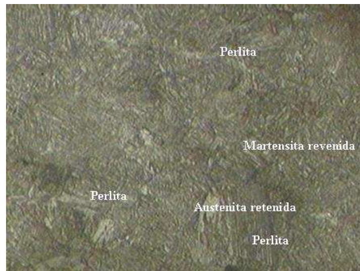
Figura 4.1 Microfotografía que muestra las estructuras metalograficas de ferrita, perlita y martensita del acero 5160H con tratamiento térmico (50X)
